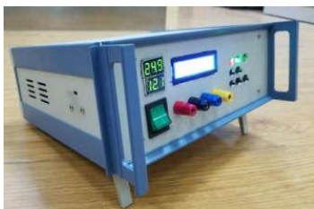
图 3 DCPD 裂纹扩展速率实时监测仪器及监测软件界面
