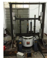
图 3 减振器特性实验系统
