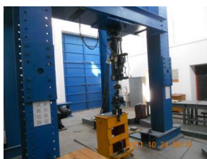
图 1 磁流变减振器试验
