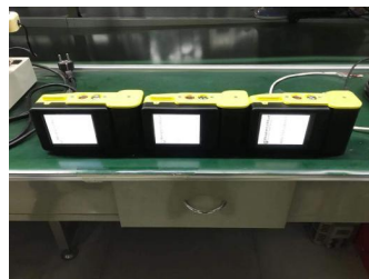
图 2 矿用本质安全型夜视仪工程样机
