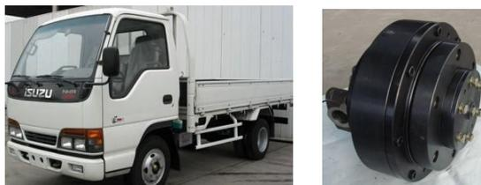
图 1 矿用胶轮车及湿式制动器实物图
