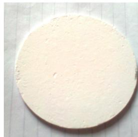
图 2 采用本专利材料制备的隔热板
