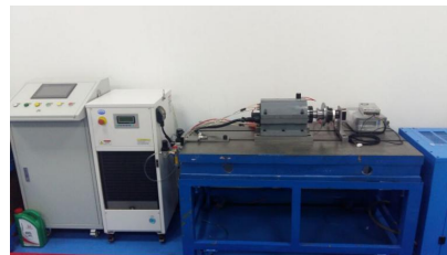
图 2 转子机械式自动平衡系统平台
