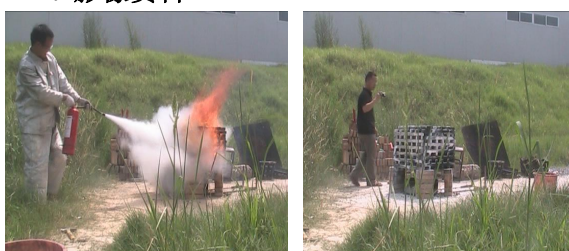
图1 新型干水灭火材料扑灭 A 类火试验视频截图
