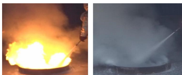
图2 新型干水灭火材料扑灭油盘火试验视频截图
