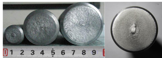
图 2 不同材质钢棒下料所得坯料
