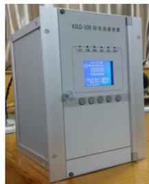
漏电保护装置
