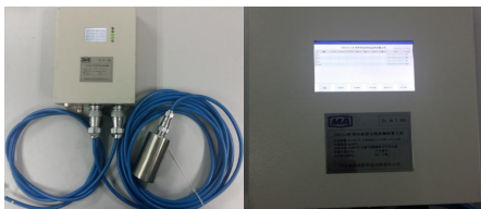
图3 煤自燃无线传感器监测系统
